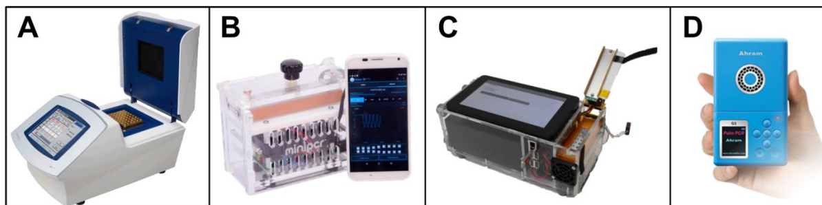
Abbildung 65 – Übersicht verschiedener ( Point-of-Care kompatibler) PCR-Geräte. (A) Sensquest® Labcycler 48s ist der in der Arbeit verwendete Standard PCR-Cycler, repräsentativ für Laborgerät. (B) mini16 thermal cycler (MiniPCR®) Preisgünstiges Gerät für Feldanwendungen und Lehrzwecke. (C) „TUB(e)-Cycler“ – in enger Zusammenarbeit mit dem Fraunhofer-Institut für Zuverlässigkeit und Mikrointegration IZM entwickelter Thermocycler für den Feldeinsatz. (D) Palm PCR™ (Ahran Biosciences) ist kein Thermocycler, sondern ein spezieller Inkubator der eine konvektive PCR ermöglicht.
